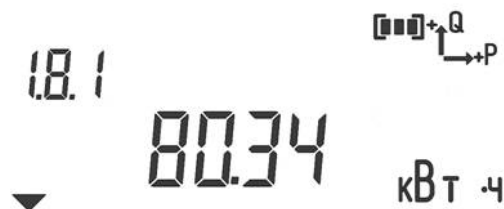
Рисунок В.4 – Пример индикации значения потребления активной энергии по 1 тарифу
