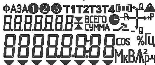
Рисунок В.5 – Пример индикации при выполнении автоматической самодиагностики и пользовательской диагностики дисплея
