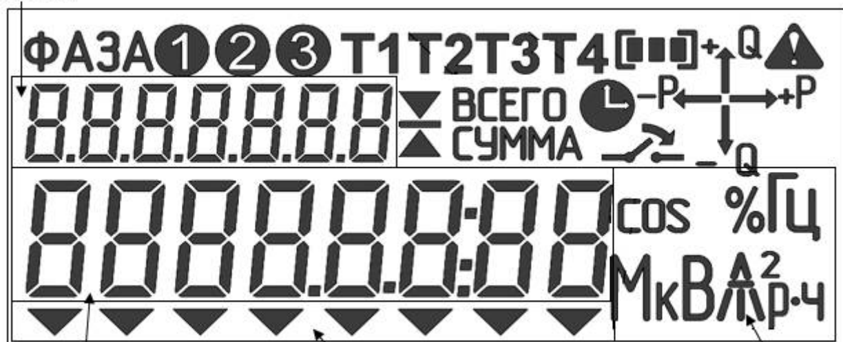
Рисунок В.1 – Расположение полей дисплея счетчика с ПО версии ниже 3.99
